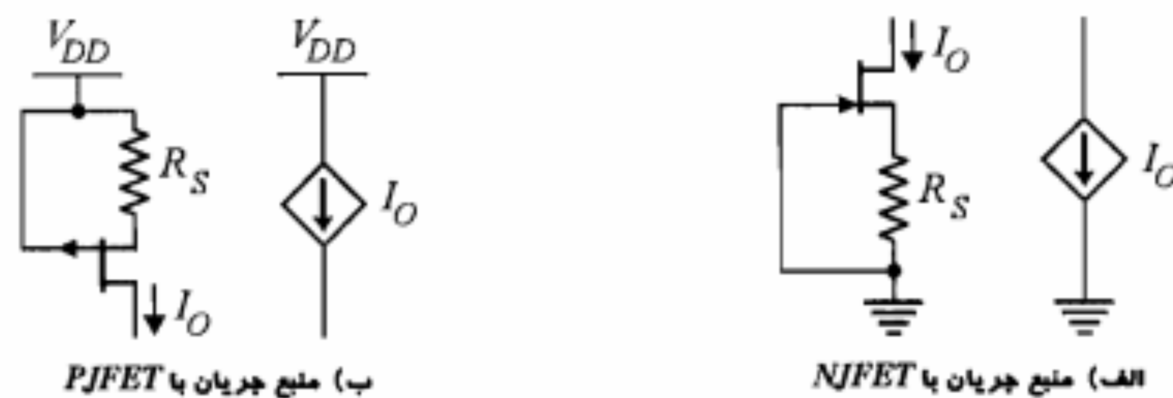
شکل ۷-۱۸: مدارهای منبع جریان با JFET
