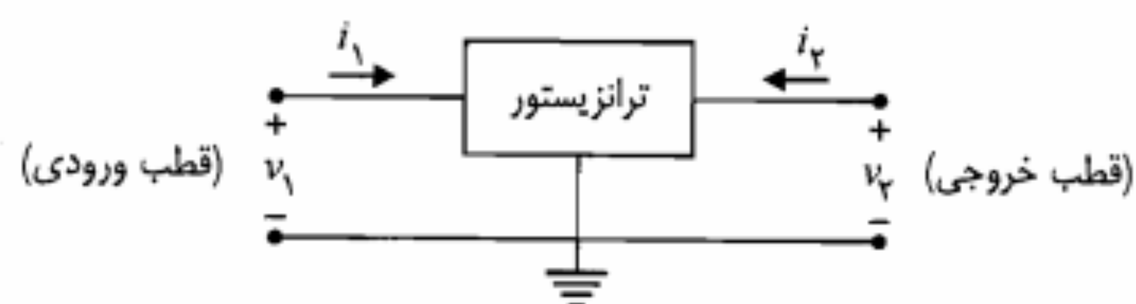
شکل ۲-۶: ترانزیستور به عنوان یک دو قطبی
